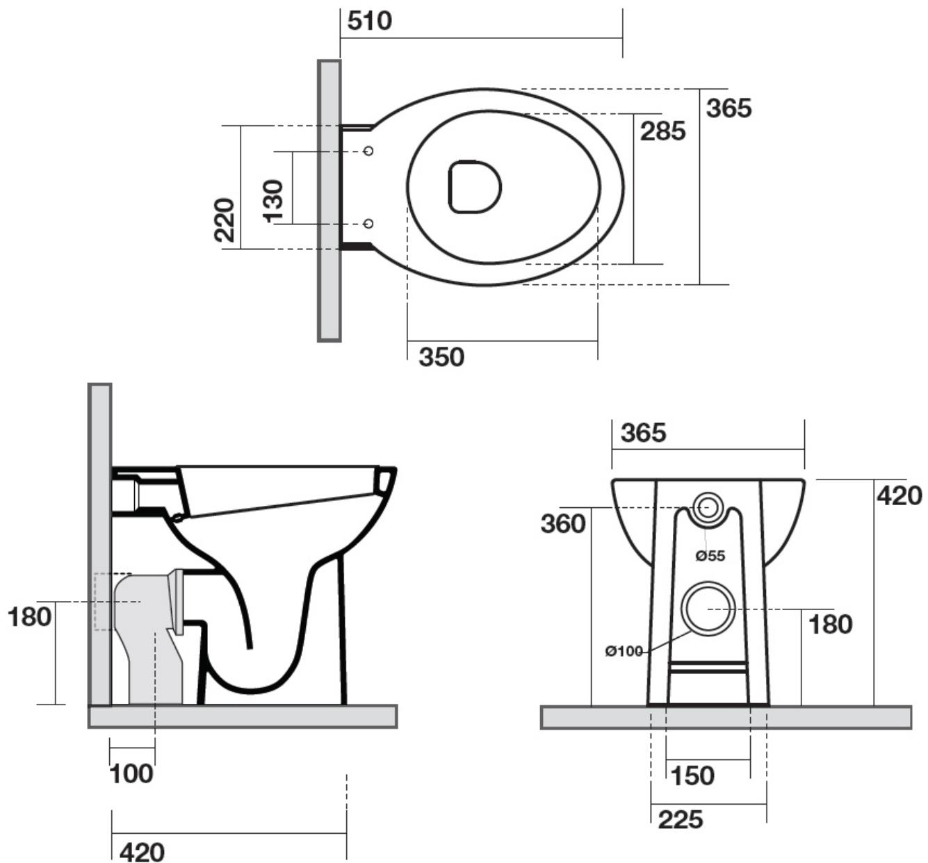
N.B.: Le misure indicate possono subire una variazione dello 0,8 % circa, dovuta ad usura stampi o a piccole variazioni delle caratteristiche tecniche relative alle materie prime che compongono l'impasto.
